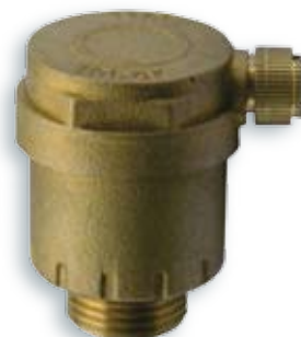
Αυτόματο εξαεριστικό δικτύου 10bar (110°C) B.T. με πλαϊνή βαλβίδα εξαερισμού 1/2" Automatic air vent with side discharging 10bar (110°C) Heavy type 1/2" 6,20 €
